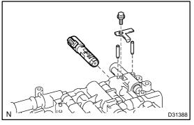
19. REMOVE SHIFT SOLENOID VALVE SL2
