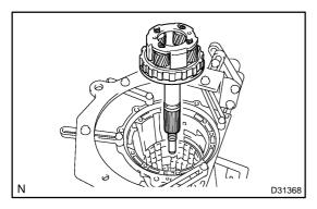
(d) Install the rear planetary gear assy.
