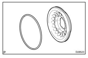
(d) Remove the O-ring from the clutch balancer No.1.
