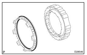
(d) Remove the 2 O-rings from the 2nd brake piston.
